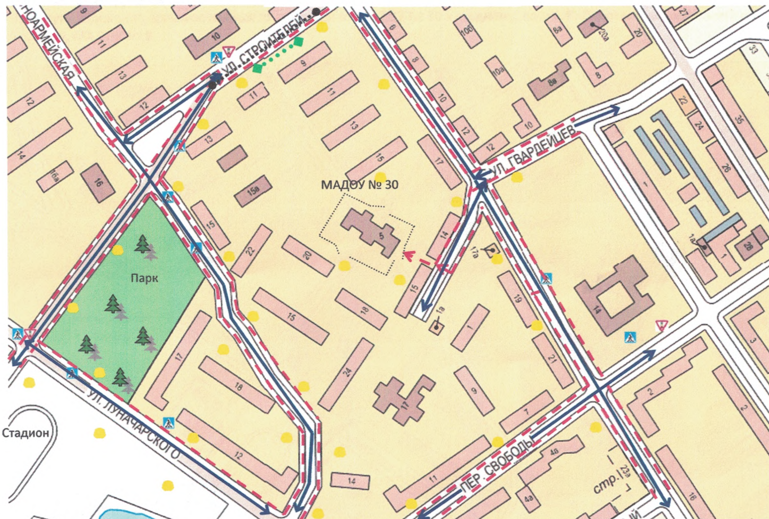
Схема организации дорожного движения в непосредственной близости от МАДОУ № 30 с размещением соответствующих технических средств организации дорожного движения, маршрутов движения детей.
